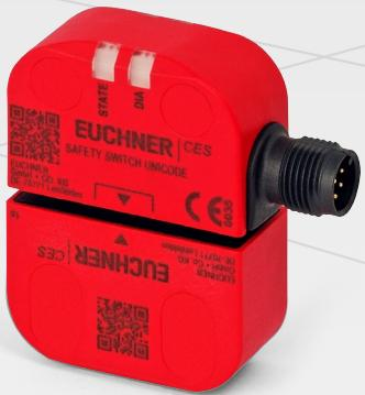
使用安全模块**ESM-CB**时，这些信息从开关链中的每个开关自动进行轮询，然后通过IO-Link提供给控制系统。毋庸置疑，该开关的特点是具备弱信号指示和非常直观的LED显示等，安全控制类别达到4级/PL e。此开关有3个不同的触发面，因此允许不同的安装方式。标准M12插头直接集成到开关中，使用标准M12电缆即可实现连接。另一大好处是您可以选择将机械式安全开关并入CES设备的串联连接。
