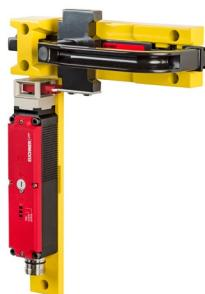
ボルツは安全ガードが閉じられている時のスイッチの機械的な保護のために設計されています。組立穴によって安全ガードへ簡単に素早くボルツを取り付けることができます。特に標準的なアルミニウムプロファイルへの取付は簡単です。ボルツには、電気機械式安全スイッチ、非接触安全スイッチのどちらでも組み合わせることができます。
