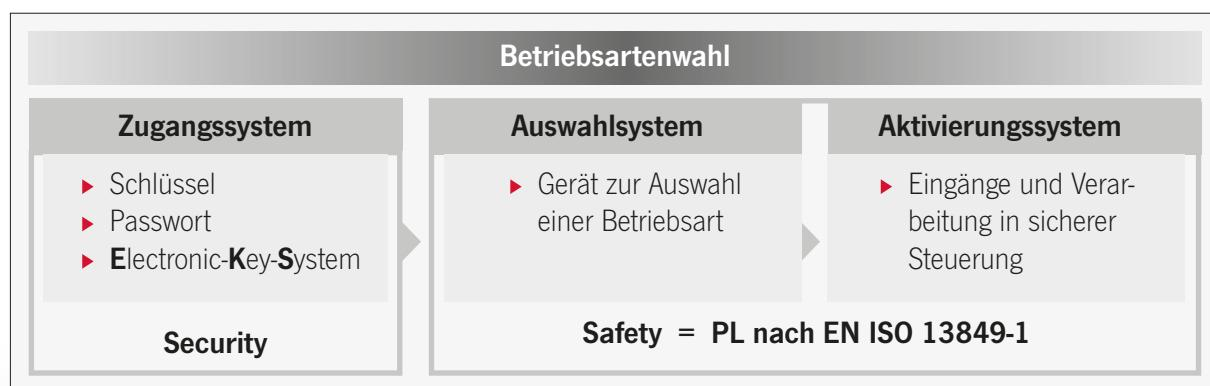
Das Zugangssystem muss nicht nach EN ISO 13849-1 ausgeführt werden. Für die Überwachung einer Berechtigung lässt sich kein PL ermitteln. Dagegen muss das Auswahlsystem zusammen mit der sicheren Steuerung einer Maschine den geforderten PL erfüllen. Das ist für mechanische Tasten oder Schaltern sehr einfach möglich.
