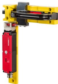
门闩的设计目的是在安全门关闭时为开关提供机械保护。通过安装孔, 用户可以轻松、快速地将门闩安装到安全门上。在标准铝型材上, 安装极其简便。门闩可以与机电式和非接触式安全开关结合使用。
